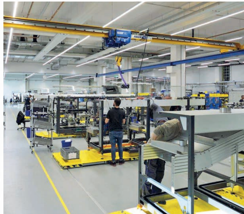
01 Rundschiensbasierte Fließfertigung ist für die Herstellung unterschiedlich dimensionierter Lötanlagen ausgelegt
