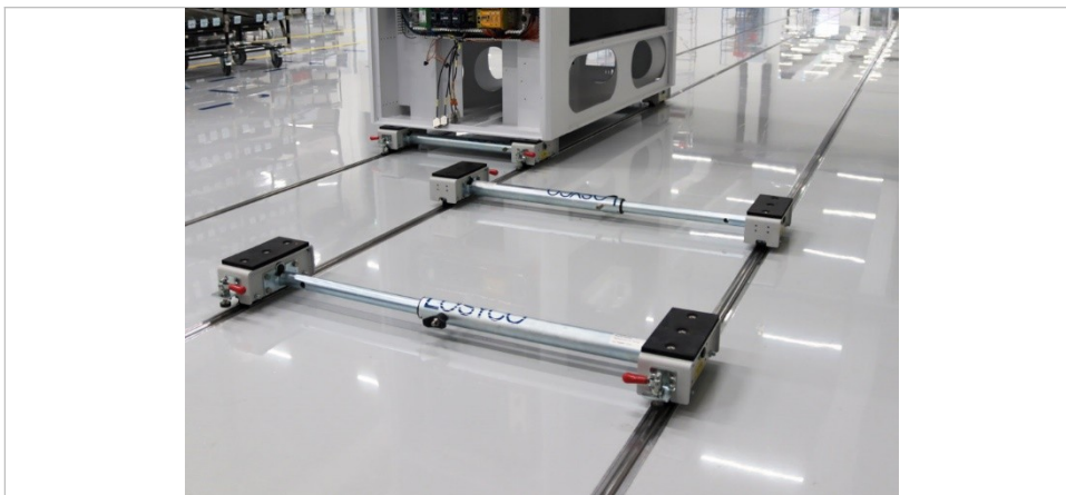
Bild: Von LOSYCO kundenspezifisch konstruierte Transportwagen mit Teleskopachse zur Befahrung von LOXrail-Schientrassen mit verschiedenen Spurweiten
