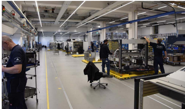
Bild 1: Das bodenbündige LOXrail®-Rundschiensysteme von LOSYCO mit den gelben Plattformen für Transport der Maschinen zwischen den Arbeitsstationen.
