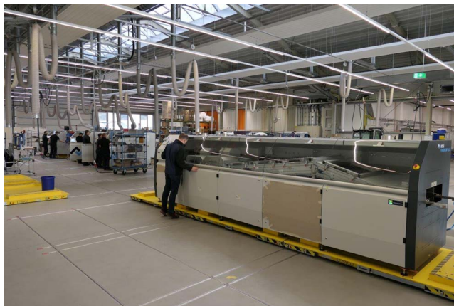
Bild 2: LOXrail®-System mit drei gekoppelten Transportwagen für die Fertigung von großen Lötmaschinen.
